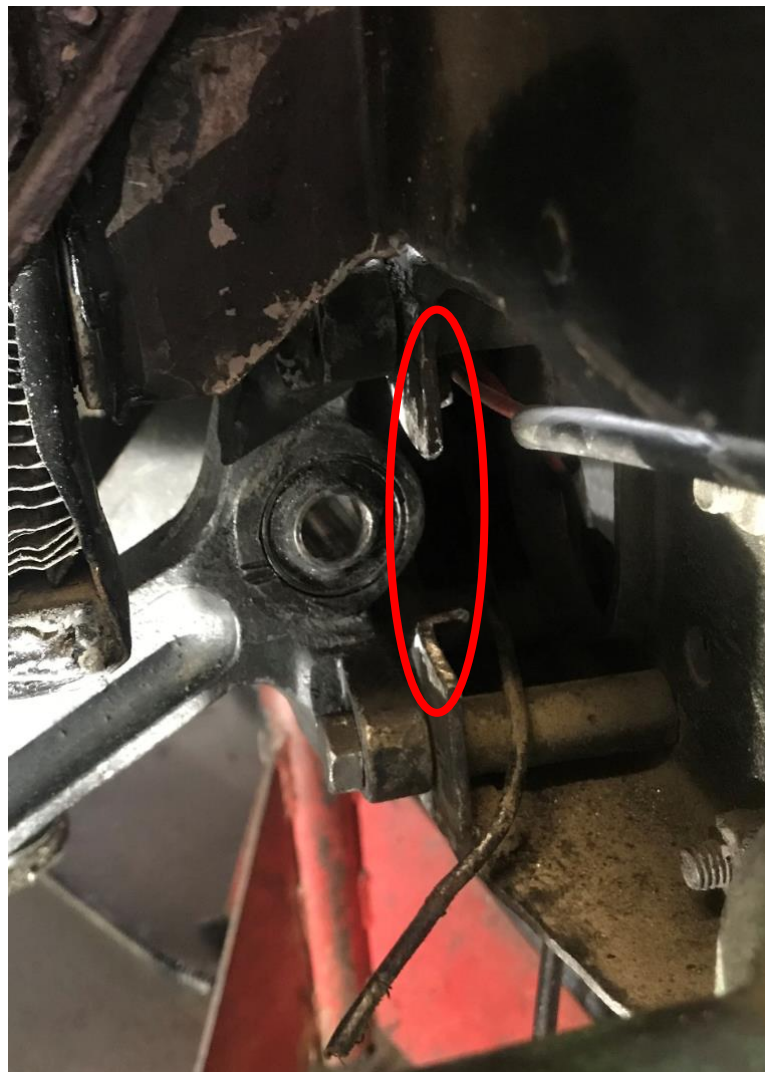
Bild 19 Die neue Lagerbuchse im Zoom! Das herausgetrennte Teil fehlt noch (rot).
