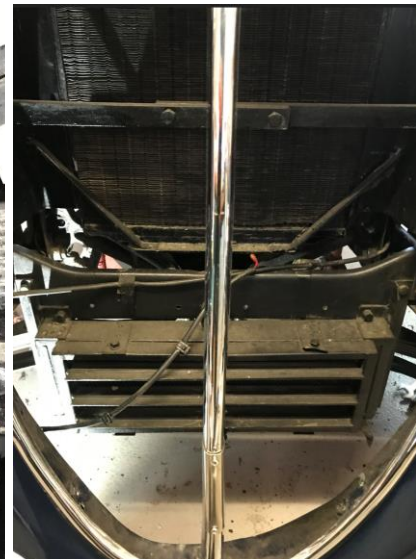
Bild 9b Ölkühler demontieren
