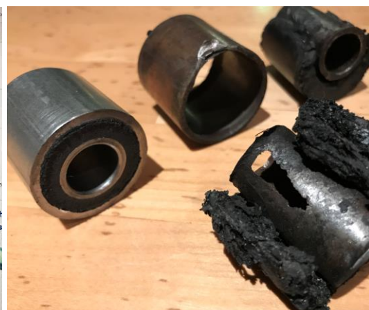
Bild 16b Alte und neue abgedrehte Lagerbuchse
