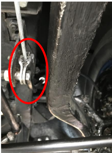
Bild 25c Seilführung für Baudenzüge
