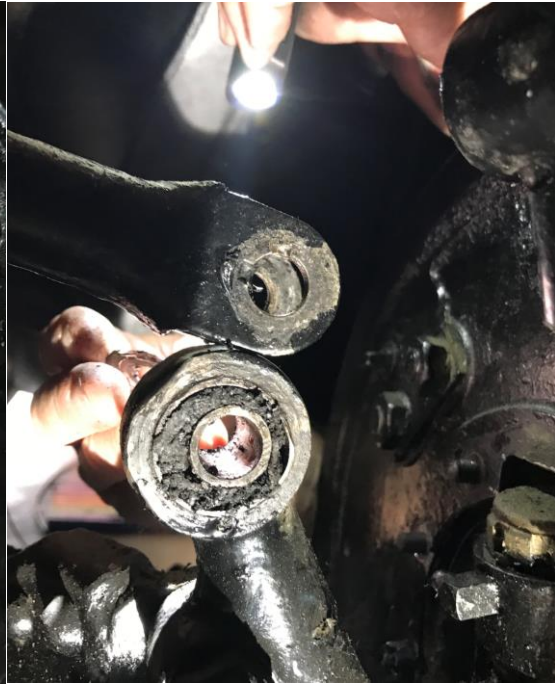
Bild 6b Uns war klar: Lagerbuchsen ersetzen!
