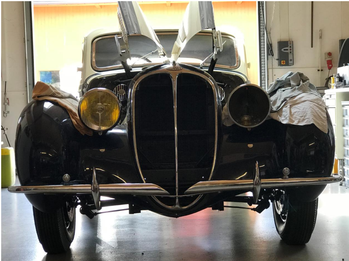
Bild 26 Der «Einäuger» steht wieder flott auf den Beinen: Sturz 3° plus!
