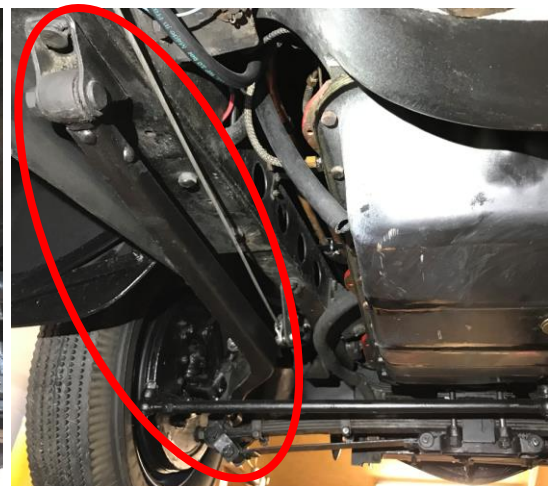
Bild 5d Längsführung durch Schubstrebe
