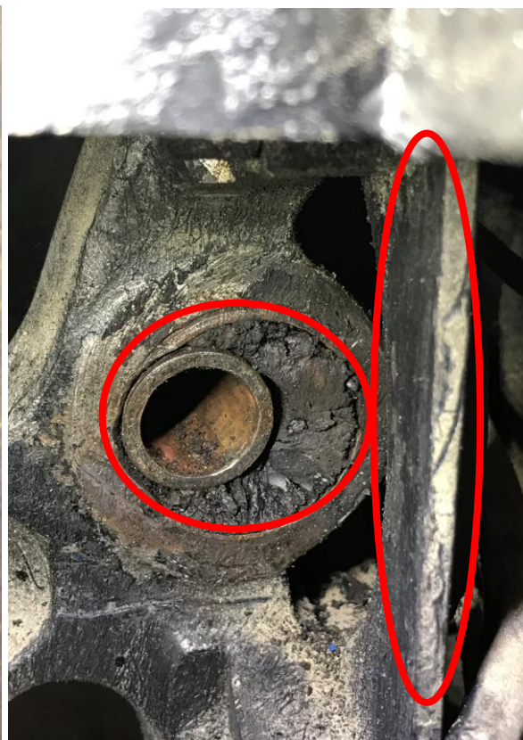
Bild 7b Lagerbuchsen im Querträger (Querträger gegen vorne nicht ausfahrbar!)
