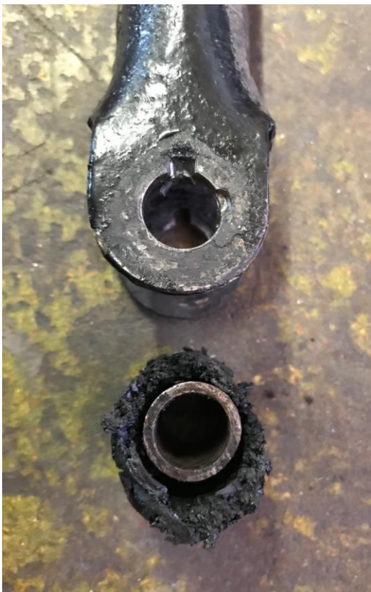
Bild 7a Wartungsarbeiten in 80 Jahren? Lagerbuchse im Querlenker
