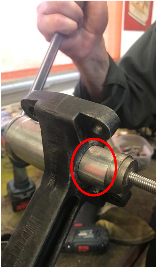
Bild 17a Lagerbuchse wird eingezogen.
